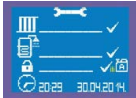
Afbeelding 18: positie van symbolen voor de selectie van regime van de ketel
